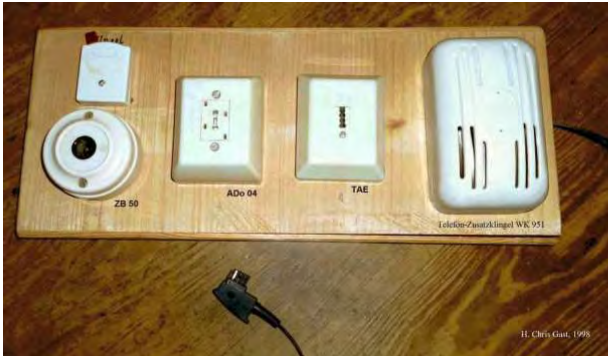
Bild 3: Brett mit Telefonsteckdosen und einer Telefonklingel
