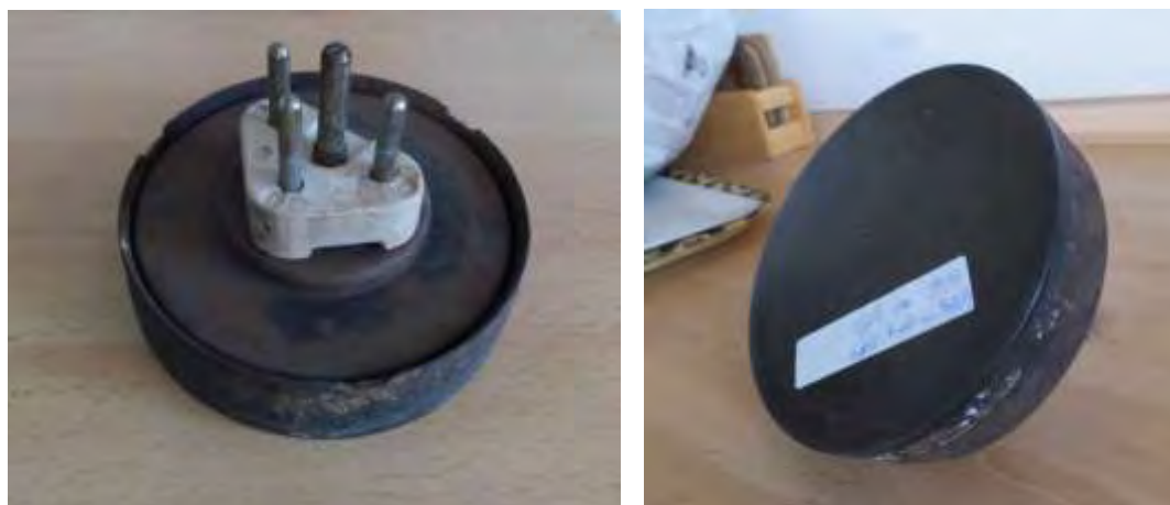
Bild 3: Defekte alte Herdplatte von 1937
