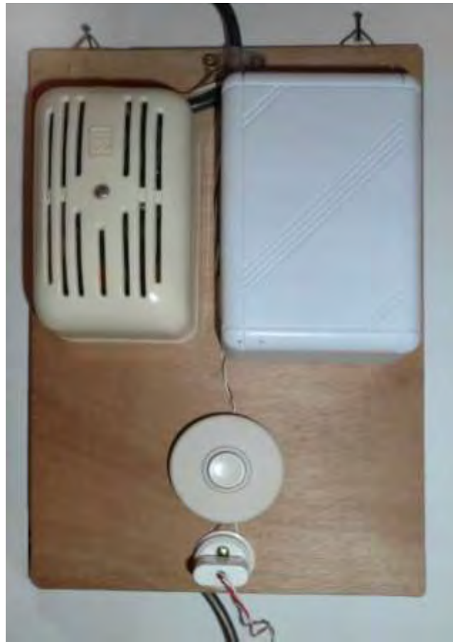
Bild 11: Schalttafel mit Ding-Dong-Klingel (Zweiklang-Gong) und Mini-Steckdose
