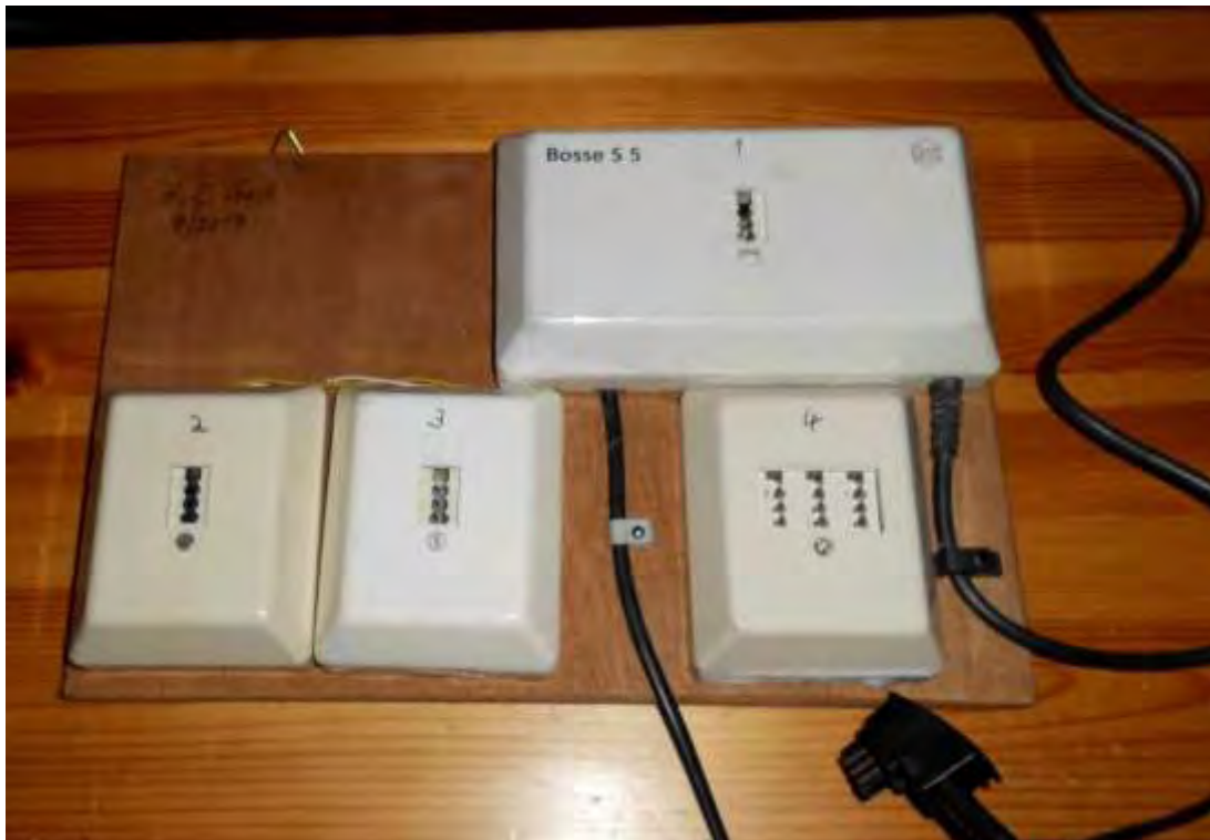
Bild 2: Die Nebenstellenanlage für vier Analog-Telefone mit Impulswahl
